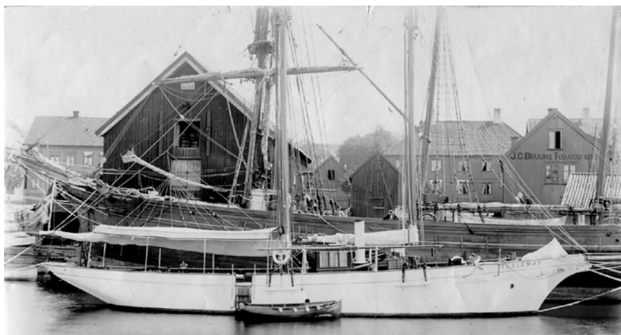
Veslemøy ved Skottebrygga i Larvik i 1897. Legg merke til skorsteinen fra dampmotoren mellom de to mastene. Motoren ble byttet ut i 1909. (Kilde: Larvik Museum).
