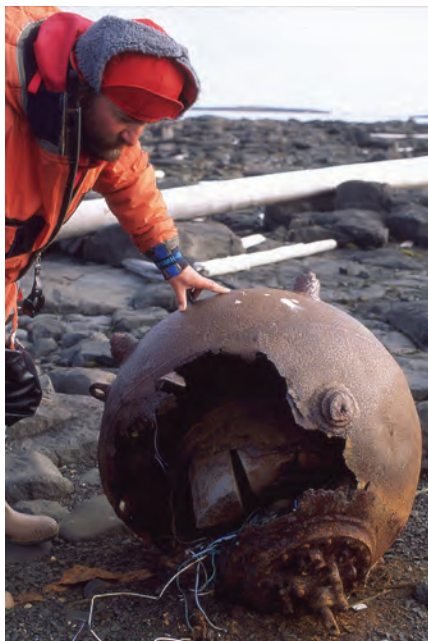
Odd Ivar Ruud gransker en gammel iland-dreven hornmine på Håøya august 1993. Minen er delvis rustet i stykker og deler av de innvendige ledningene synes. (Foto: I. Gjertz).
