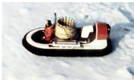
Fig. 1. Nordpolen september 1991. Liten luftputebåt med seismisk kabel under operasjon ut fra isbryteren Polarstern . (Foto: V. Schultz).
